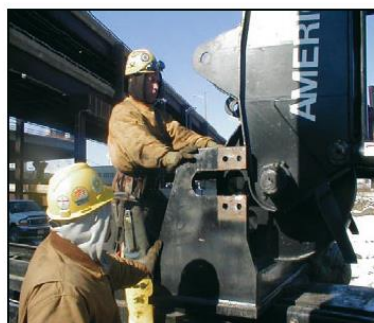
соединительное устройство верхней части стрелы, проверенное рентгеном
