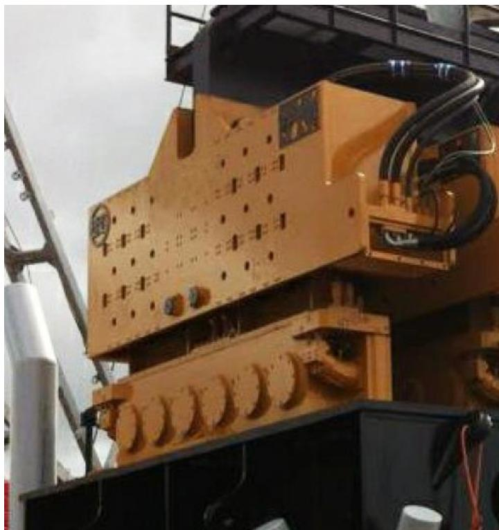
Технические характеристики вибропогружателя Модели 600B
